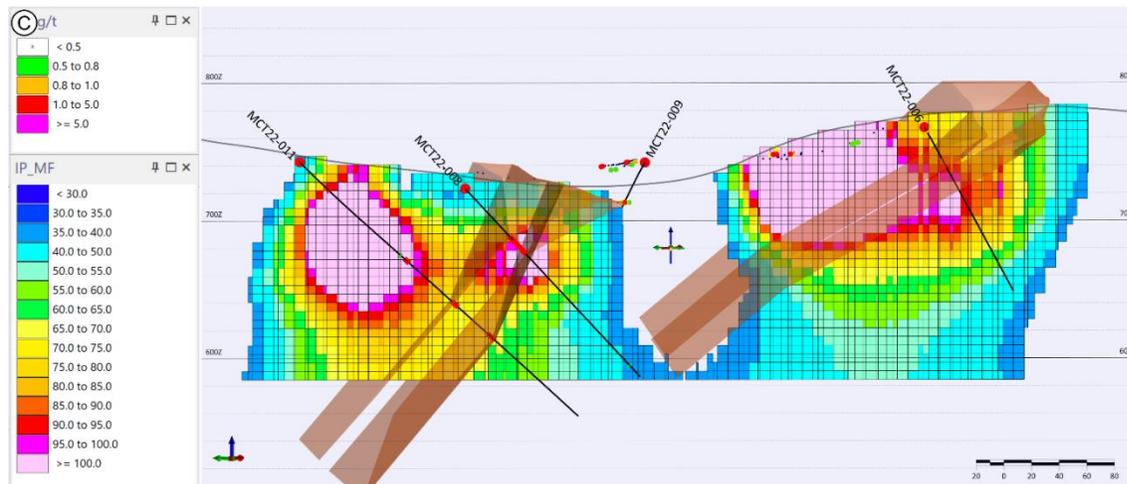
C. Un modèle 3D préliminaire construit dans la zone de la section PP indique deux couches minéralisées au pendage vers le NNO recoupant également des zones de haute chargeabilité.
