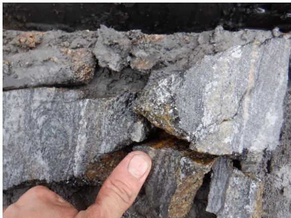
Figure 7 : Paragneiss avec 2-5 % de veinules de quartz, 2-6% sulfures (arsénopyrite et pyrrhotite) échantillonné en rainure de 1 m de long. / Paragneiss containing 2-5 % quartz veinlets, 2-6% sulfides (arsenopyrite and pyrrhotite) in a 1 m-long channel sample.
