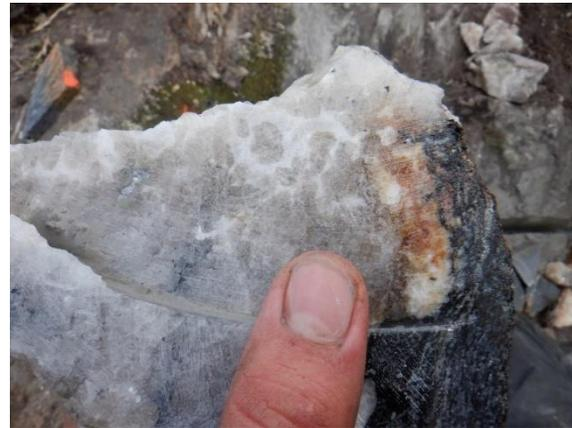
**Figure 7 : Veine de quartz et feldspaths avec traces arsénopyrite. / Quartz feldspar vein with traces of arsenopyrite.**
