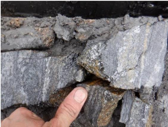
**Figure 6 : Paragneiss avec 2-5 % de veinules de quartz, 2-6% sulfures (arsénopyrite et pyrrhotite) échantillonné en rainure de 1 m de long. / Paragneiss containing 2-5 % quartz veinlets, 2-6% sulfides (arsenopyrite and pyrrhotite) in a 1 m-long channel sample.**
