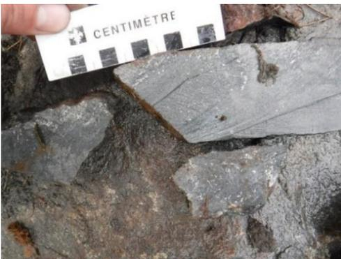
**Figure 8 : Amphibolite avec 2-6% sulfures (arsénopyrite, pyrrhotite et pyrite) échantillonné en rainure de 1 m de long. (2.2 g/t Au) / Amphibolite containing 2-6% sulfides (arsenopyrite, pyrrhotite and pyrite) in a 1 m-long channel sample.**
