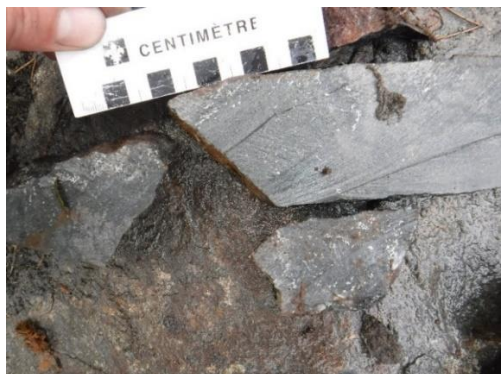
Figure 9 : Amphibolite avec 2-6% sulfures (arsénopyrite, pyrrhotite et pyrite) échantillonné en rainure de 1 m de long. (2.2 g/t Au) / Amphibolite containing 2-6% sulfides (arsenopyrite, pyrrhotite and pyrite) in a 1 m-long channel sample.
